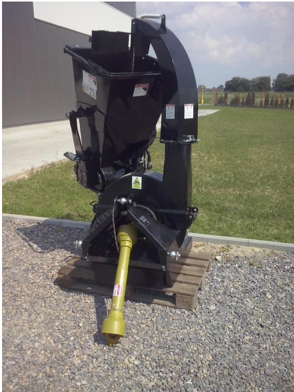
Fot. Rębak do rozdrabniania gałęzi i drzew
